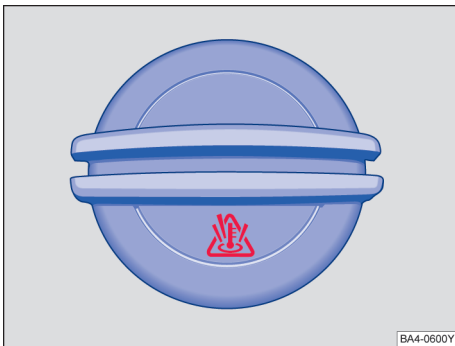
图 194 冷却液补偿容器盖
