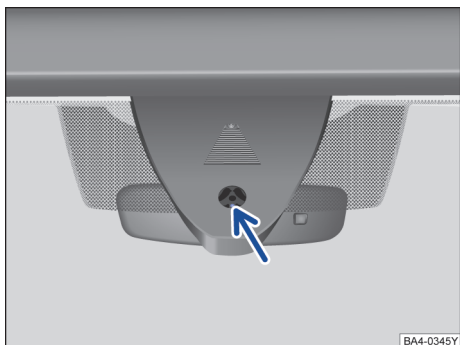
图 95 雨量传感器的传感表面
